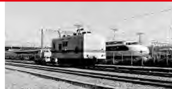
東海道新幹線の開業に向けて開発された超音波レール探傷車
