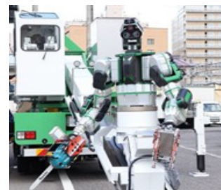
多機能鉄道重機
