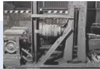
重錘型緊張機 “てこ”の原理を応用 (当社技術研究所にて保管)
