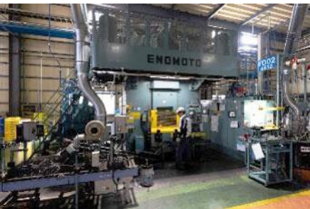
当社独自工法のスクリーブレス式熱間鍛造
