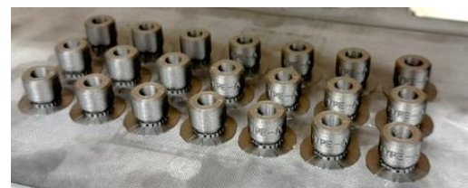
カーボンケブラー材を使用した3Dプリンタによる治工具(センターピン)
