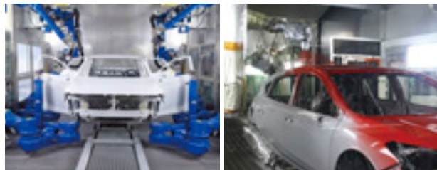
塗装ブース内の様子
