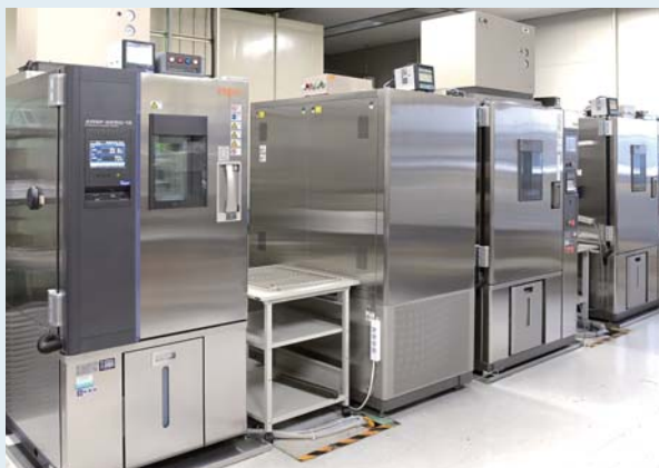
エスベック製 ハイパワー恒温(恒湿)器 ARシリーズ(写真左) 温湿度範囲：-70～+180℃、10～98%rh 温度変化速度：18℃/分(-45⇄+155℃)
