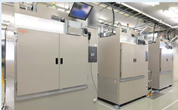
SSD向け評価試験装置 (テスター)
