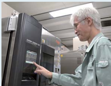
エスベック製 ハイパワー恒温(恒湿)器 ARシリーズ(写真左) 温湿度範囲：-70～+180℃、10～98%rh 温度変化速度：18℃/分(-45⇄+155℃)
