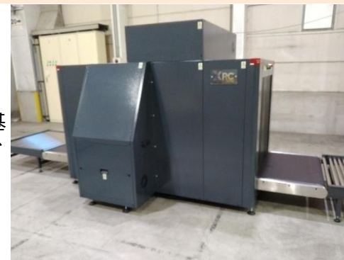
【X線検査装置の導入】 KS/RA制度の厳格化に伴い非KSの貨物に対して内容物の検査が必要となるが、X線検査装置の導入により、開梱することなく検査可能となる
