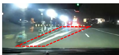
LEDプロジェクター 走行評価（車内から撮影） 赤枠内の矢印が投影した車線誘導表示
