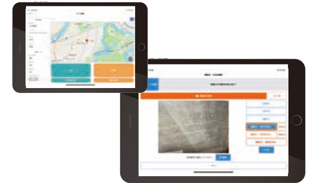
AI橋守ヘルパーの画面(左上:橋梁位置表示、右下:損傷判定画面)
