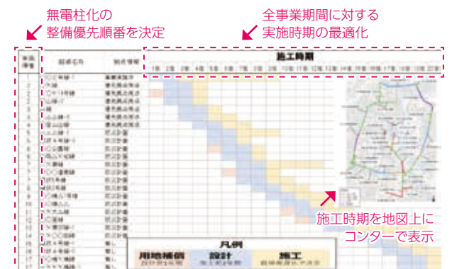
DN-RAMSによる最適化結果(制約条件に応じた工事工程表の出力)
