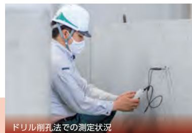
ドリル削孔法での測定状況
