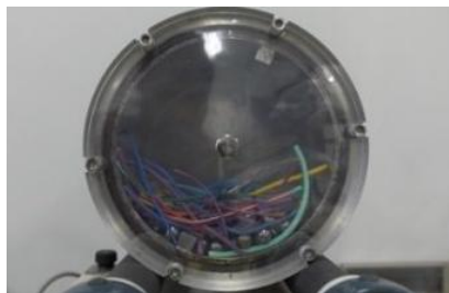
有機溶媒によって膨潤した電線の被覆材を剥離する様子
