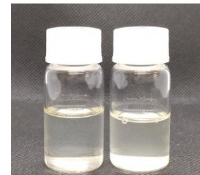
新開発の電子輸送層成膜用酸化スズナノインク
