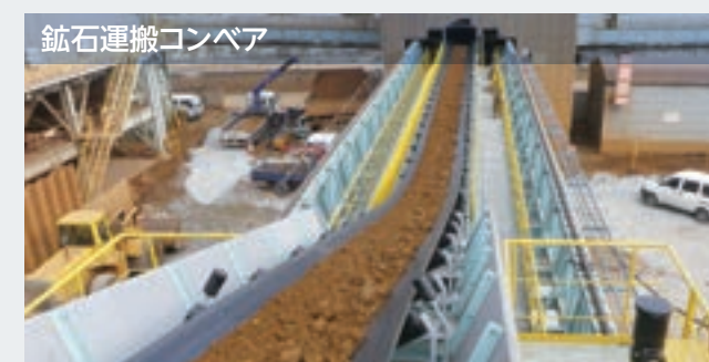
鉱石運搬コンベア 荷下ろしが終わった鉱石等を、総延長2.4kmに及ぶコンベアで工場まで運びます。
