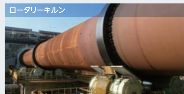
ロータリーキルン 全長100mを超える煅焼設備であり、乾燥した鉱石等を約1,000度まで熱し、熱処理します。
