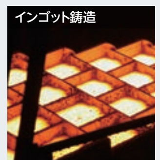
インゴット casting 溶湯を鋳型に流し込んで20kgのインゴットに仕上げます。
