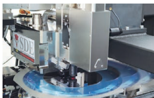
▲ステルスダイシングエンジン（左）。レーザ光によりウェーハ内部にき裂を生じさせることでウェーハを切断します（右）。
