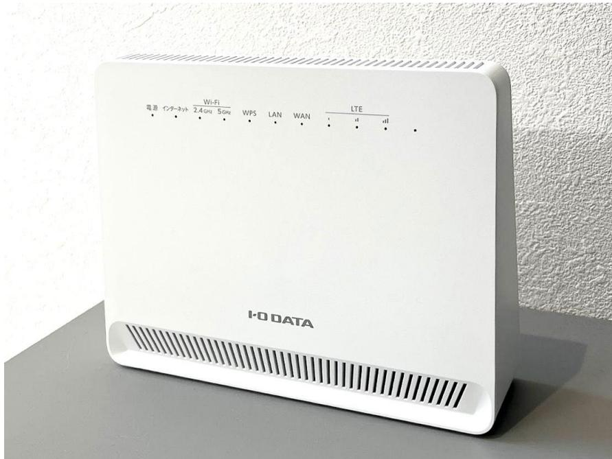
「UD-LTA」は、LTE 通信に対応したアンテナ内蔵型の Wi-Fi ルーターです。既存のネットワークが利用できない場所や固定回線の敷設が困難な場所、イベント会場などの一時的な設置場所でも、SIM を設定した本ルーターを利用することで、短期間でネットワークを構築できます。一台のルータ
