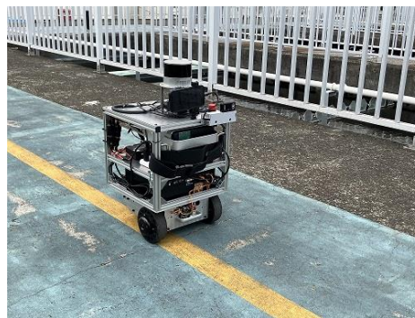
下水処理場内で 点検ロボットの实証
