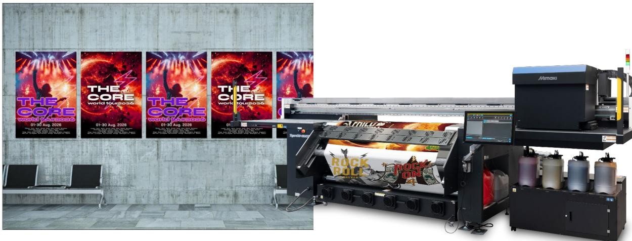
「Tiger600-1800TS」は、当社独自の画像処理技術と高速駆動ヘッドの組み合わせにより、高い生産性と高画質を両立し、テキスタイルプリント用途で高い評価をいただいている昇華転写用インクジェットプリンタです。その最大の特長である“高速で、美しい”表現力を、ポスター・POPのグラフィックプリント用途向けに市場展開するため、新たに開発した水性顔料インク「AP50」を搭載可能としました。
