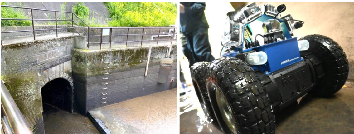
東北電力 人来田発電所の導水路(左)と点検用 AGV(右)
