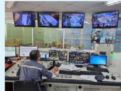
カメラ・モニターの設置(SUNSCO社) 350台以上のカメラを工場内に配置し、操業状況や作業状況を常時モニタリング
