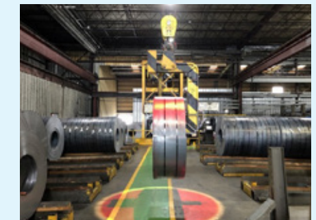
クレーンにレーザーライトの設置(MAC社) レーザーライトにより吊り荷の位置を把握して、進行方向と退避距離の確認に役立てる
