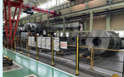
安全柵の設置推進(全工場) 安全柵を機械周辺に設置してインターロック化を図る
