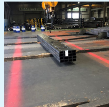
クレーンにレーザーライトの設置(MAC社) レーザーライトにより吊り荷の位置を把握して、進行方向と退避距離の確認に役立てる
