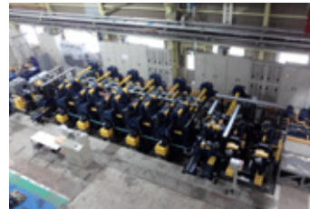
DRW装置（溶接位置のねじれ強制装置）
