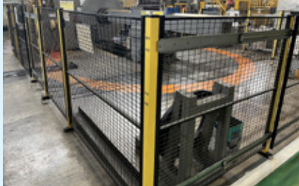
安全柵の設置推進(全工場) 安全柵を機械周辺に設置してインターロック化を図る
