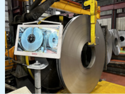
コイル投入カメラとモニターの設置(MAC社) 作業者の動線とコイルを吊り上げるクレーンの動線切り離し、安全を確保
