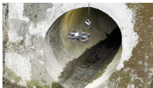
管渠に進入する ELIOS 3
