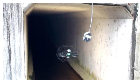
ボックスカルバートに進入する ELIOS 3
