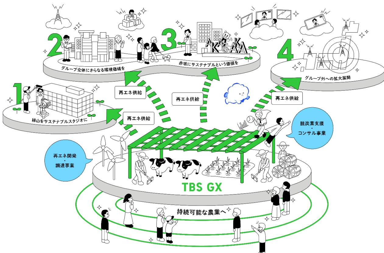
\*1 営農型太陽光発電：農地に太陽光発電パネルを設置して発電する取り組み。太陽光を作物と発電でシェアすることから、ソーラーシェアリングとも呼ばれています。パネル設置にあたっては地上権の賃借料などを支払うため、農家の安定収入につながり、持続可能な農業の実現に貢献。地域社会や経済の維持にもつながると期待されています。
