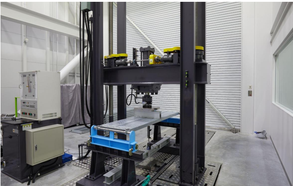
研究開発拠点であるTakamiya Lab. West（兵庫県尼崎市）に設置されている実大試験機
