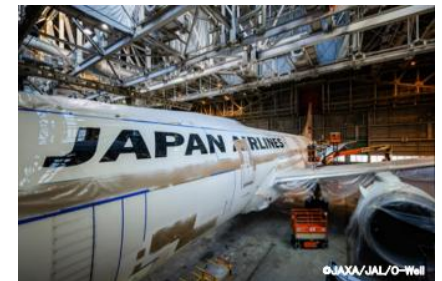
リブレット施工作業風景
