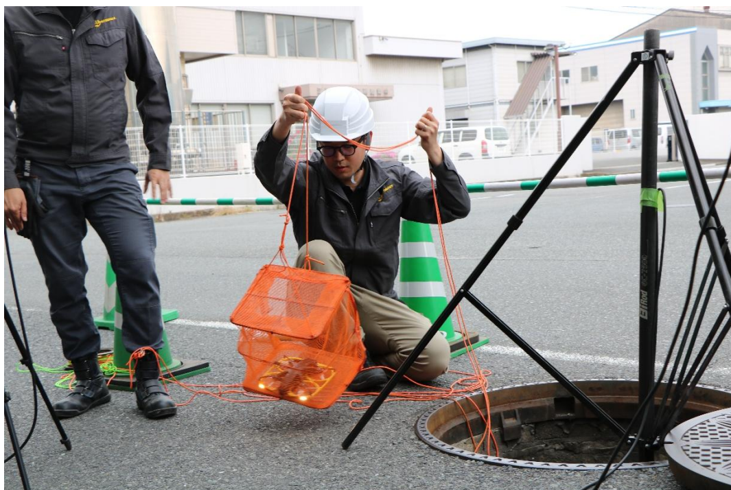
〈下水道管に IBIS2 を進入させる様子〉
