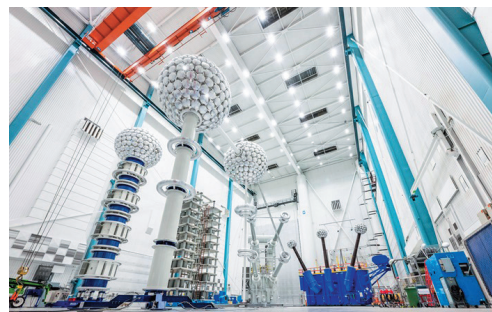
Hitachi Energy社のHVDC変圧器試験設備（スウェーデン ルドヴィカ）
