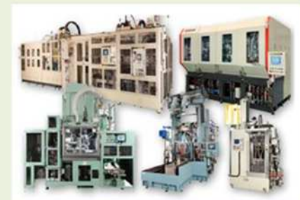
高周波焼入設備
