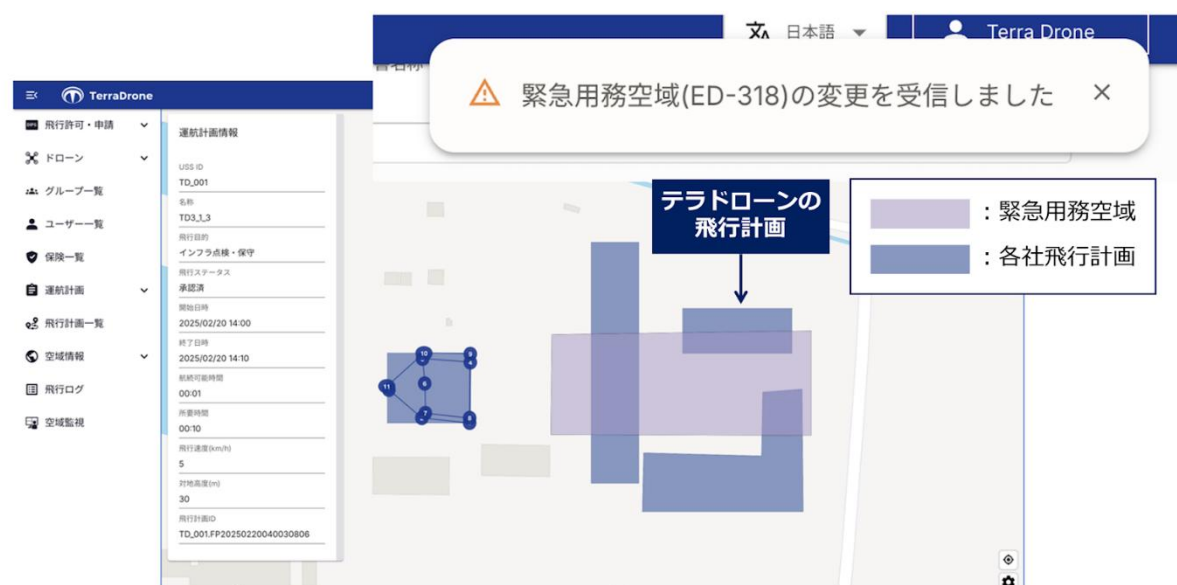
Terra UTM 画面：設定された緊急用務空域が可視化され、各社飛行計画と重複している様子
