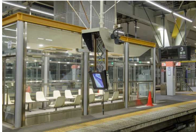
泉佐野駅 3 番のりばの昇降式モニターハウジング ※モニター部を引き下ろした状態、通常は上部に格納
