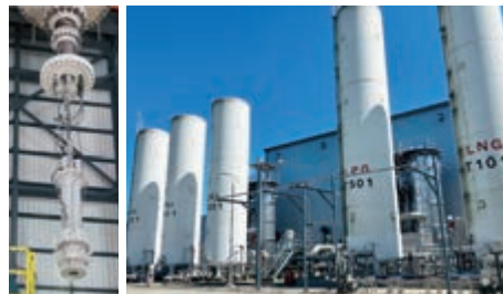
左：試験後のアンモニアポンプ 右：クライオジェニックポンプ試験設備
