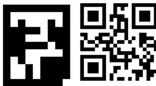
二次元コードシンボルの例(左:「AsCode」、右:QRコード(※2))
