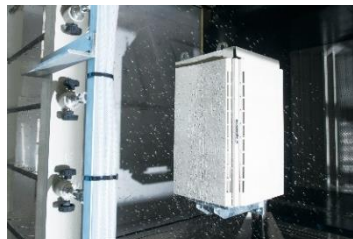
自社設備で屋外キャビネットの 風雨性能評価試験等を実施
