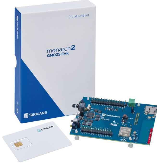
今回提供される評価キットは2種類です。低消費電力が特徴の通信規格LTE-M/NB-IoTに対応した「Sequans Monarch2 GM02S EVK」は、スマートユーティリティメーター、産業用センサー、健康およびフィットネストラッカーなどバッテリーで駆動するようなデバイスに最適です。
