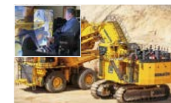
無人ダンプトラックと遠隔操作仕様の 超大型油圧ショベルの協同作業 (2023年3月開発完了)
