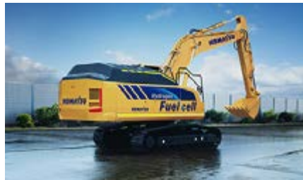
水素燃料電池を搭載した中型油圧ショベルのコンセプトマシン
