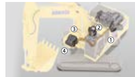
ハイブリッドコンポーネント ①発電機モーター ②旋回電気モーター ③インバーター (変換器) ④キャパシター (蓄電器)
