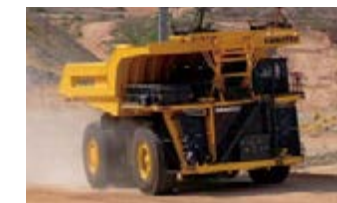
鉱山向けトローリー給電式 バッテリーダンプトラック (コンセプトマシン)
