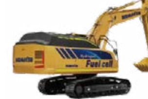
水素燃料電池搭載 中型油圧ショベル (コンセプトマシン)
