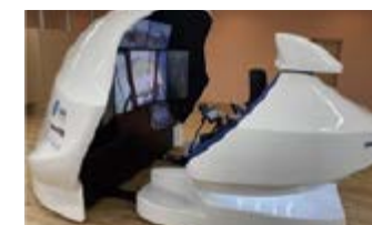
建設機械向け 遠隔操作用コックピット (量産検証中)
