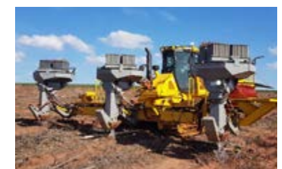
ブラック社製アタッチメントをブルドーザーに 取り付けた植林機
