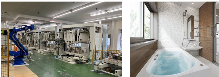
左:アクリル人造大理石浴槽の製造ライン / 右:システムバス「グランSPA」
