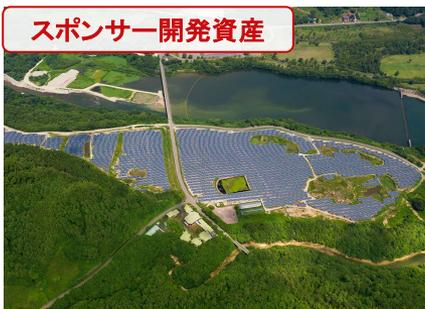
冬季の雪に備え、両面発電パネルを使用して発電効率を追求。遊園地跡地を再利用した発電所
