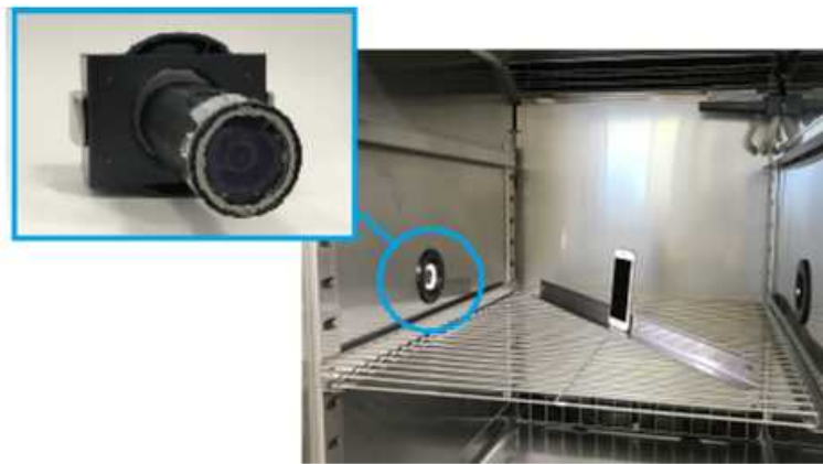
槽内監視カメライメージ
