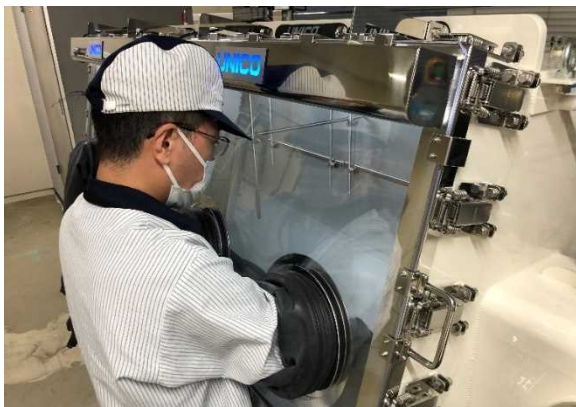
セル解体用グローブボックス
