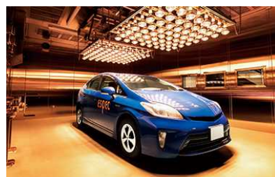
自動車一台入る 実車試験装置
