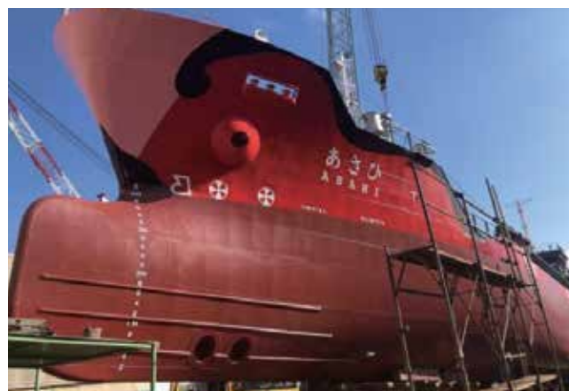
建造工事中の電気推進タンカー「あさひ」(シープレミア 3000 PLUS 塗装後)
