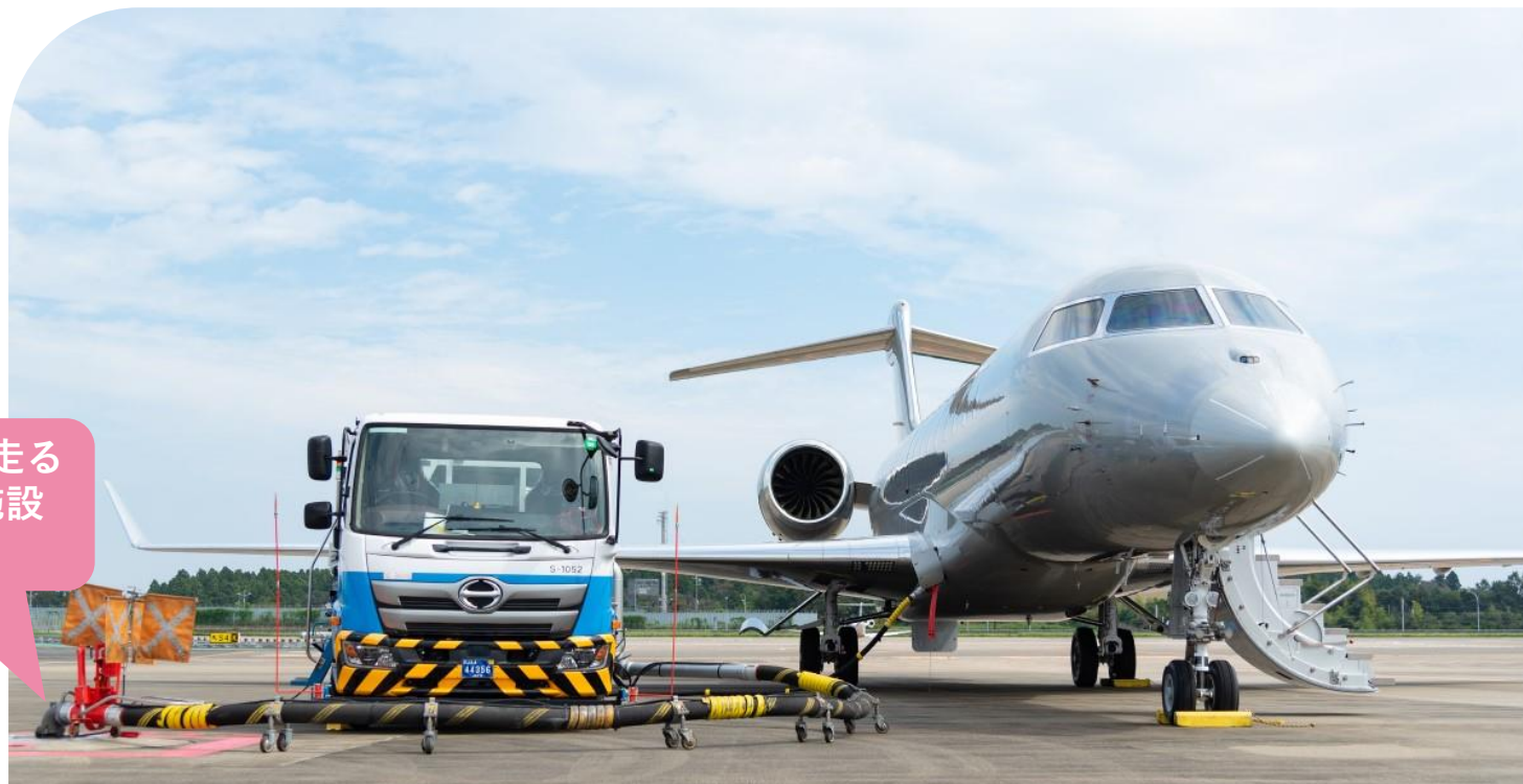
成田空港ハイドラント施設からの給油の様子 2022年9月
