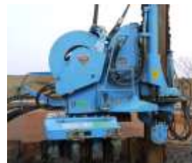
サイレントパイラー工法
