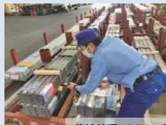
物流管理システム：製品のQRコードを読み取ることで情報を確認可能。情報のデータ化により部門間の情報共有もスムーズに。
