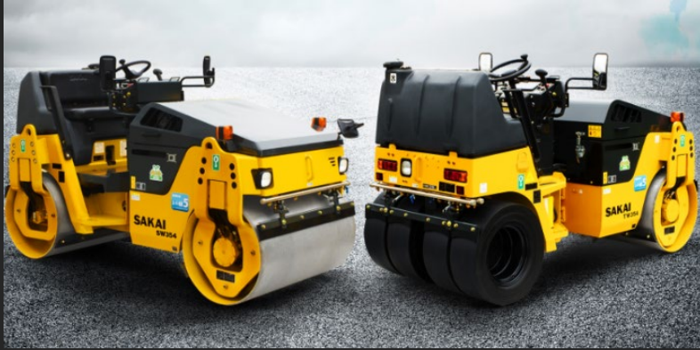
タンデムローラ(左)・コンバインドローラ(右) 市街地の中小型舗装工事で使用
