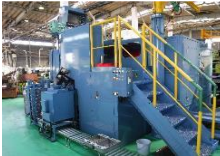
安定品質・安定供給・コスト削減を目的に、 当社野田工場に7段パーツフォーマーを導入
