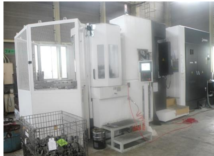
安定品質・安定供給・コスト削減を目的に、 (株)IKKにマシニングセンターを導入
