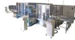
パネル解体装置
