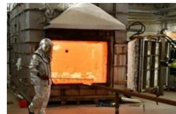
【ピット炉での鋼片加熱の様子】
