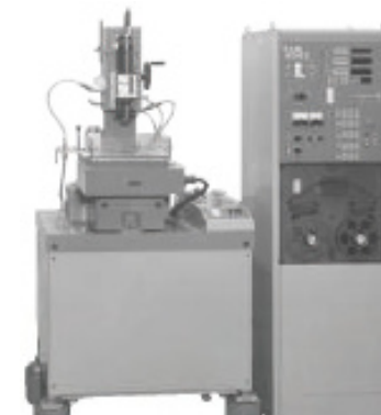
▲マイクロコンピューター付き NC形彫り放電加工機 第1号
