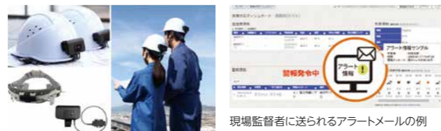
センサデバイスをヘルメットに装着した状態
