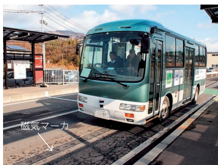
超高感度MIセンサを用いた 磁気マーカシステムが搭載された 自動運転バス (大船渡線BRT 竹駒駅 (岩手県陸前高田市)にて)
