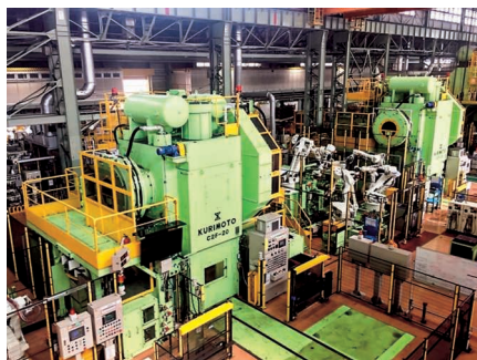
モーターによる自動制御とコンパクト化を同時に実現した新ローリングミルライン
