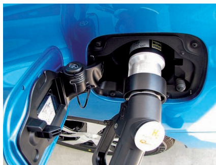
水素充填用ノズルやFCVの充填口に採用された高圧水素用ステンレス鋼
