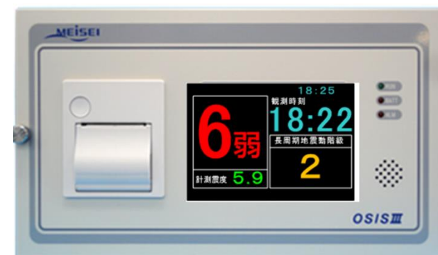
長周期震度計 (高層ビルの防災に不可欠)
