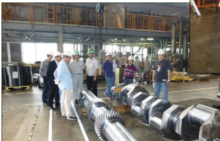
産業機械用歯車付シャフト・船舶エンジン用クランク軸 (長さ約 2,200mm) (長さ約 3,900mm)
