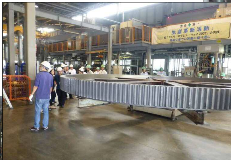
トンネルマシン用 歯車付回転ベアリング (外径8,000mm)
