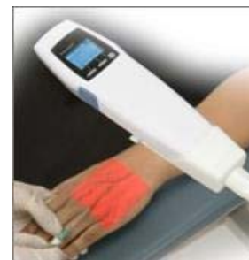
非接触型静脈可視化装置 「Stat Vein 」
