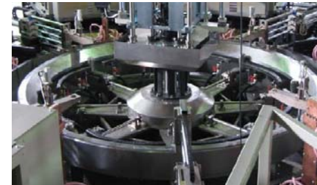
(外形3m大型リングの焼入れ)
